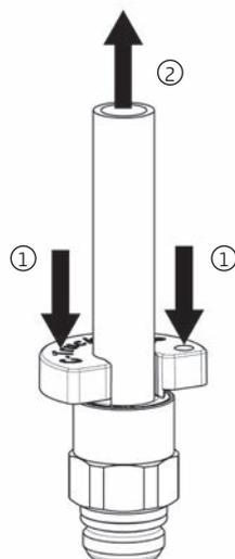
Для демонтажа трубки необходимо нажать на защитный колпачок фитинга, используя специальный ключ Мод. DRK, при этом усилие передается на торец цанги. Цанга, перемещаясь, выходит из зацепления с трубкой. Удерживая ключ в нажатом положении, извлечь трубку из фитинга. Соединение, находящееся под давлением, является неразборным. Демонтаж трубки из фитинга находящегося под давлением представляет опасность и может привести к травме.
