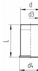
\* Используется для соединения с пластиковыми трубками
