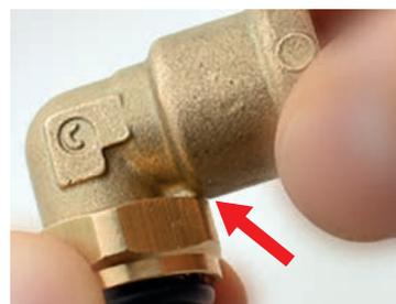
2. Вворачивать фитинг в резьбовое отверстие до тех пор, пока уплотнительное кольцо не коснется поверхности фаски резьбового отверстия. Это может быть сделано вручную или с помощью инструмента (Комментарий: Мы рекомендуем выполнять это вручную (Рисунок А), чтобы иметь хорошую осязательную обратную связь после достижения правильного положения).
