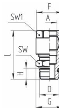
\* При применении фитинга с пластиковой трубкой необходимо в трубку устанавливать гильзу модель 1320... в зависимости от внутреннего диаметра трубки
