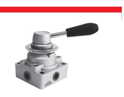
Пневматические распределители 4/2 и 4/3 лин.поз с ручным управлением. Могут быть закреплены на плоской поверхности при помощи 4-х винтов или закреплены панельно, используя фиксирующую гайку на корпусе.
