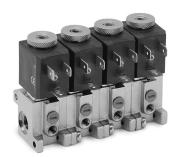
Электропневматические распределители прямого действия Серии А могут работать на воздухе как с распыленным маслом, так и без масла. Они поставляются 2/2 и 3/2 лин./поз. нормально закрытые (Н.З.) или нормально открытые (Н.О.). Также они могут иметь различное исполнение корпуса – с резьбовыми отверстиями для подключения трубопроводов и приточного исполнения – для наиболее полного охвата всех случаев применения.
